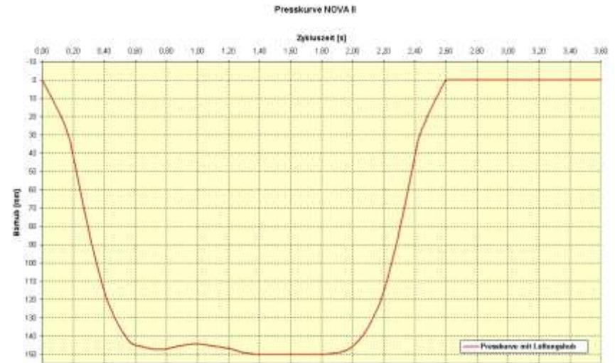
Die frei programmierbaren Presskurven können bei Formatwechsel sehr schnell am Bedienpult per Knopfdruck dem Produkt angepasst und abgespeichert werden
